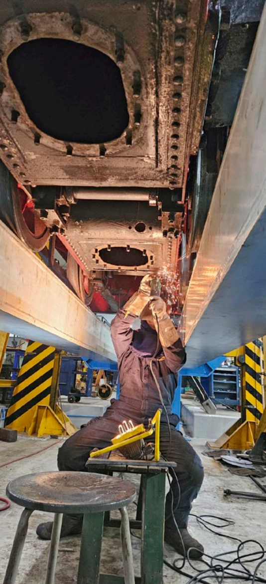
Boven: Juljen Dol (li) en Björn van Es reinigen de binnenzijde van de waterbunker van loc 5, een smerig klusje. Links: De bodem blijkt zo dun dat besloten wordt die volledig te vervangen.
