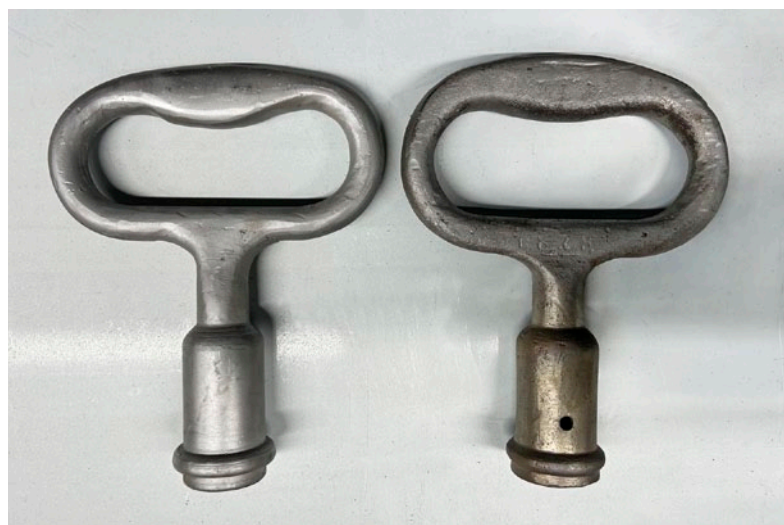
Na wat uurtjes werk is er een nieuwe handgreep voor de zanddom (II) die niet te onderscheiden is van het origineel. Foto: Roel Koolen.
