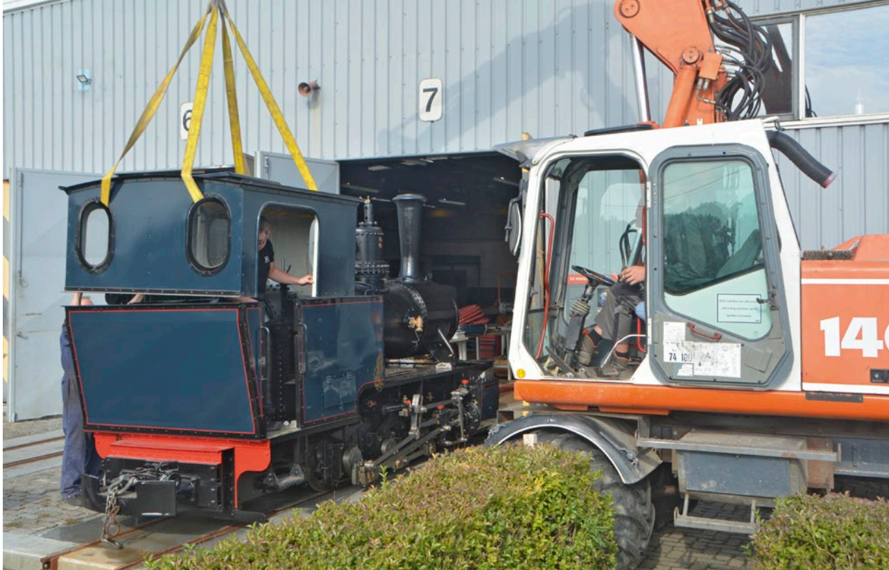
Op zaterdag 27 september wordt de bovenbouw van het machinistenhuis op de onderbouw gezet met de bedoeling de juiste positie en het verloop van de nieuw te maken stoomleidingen te kunnen bepalen. Foto: Gerard de Graaf.
