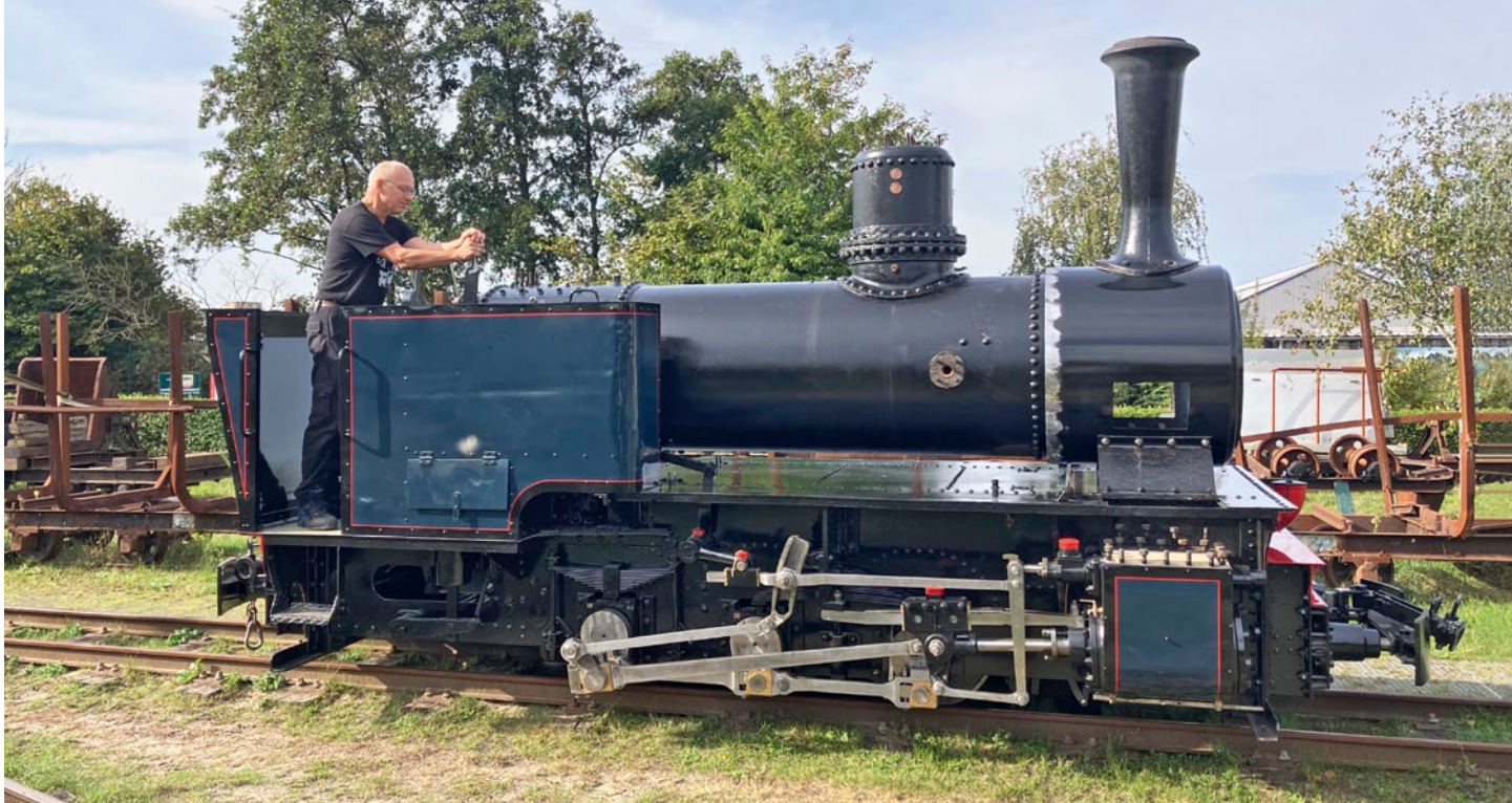
Vergeleken met de inzet op de omslag zijn we alweer een stuk verder met de opbouw. Ketel en machine zijn weer één geheel. Op de loc Roel Koolen, één van onze medewerkers die werkt aan de restauratie. Valkenburg zaterdag 20 september 2025. Foto: Ivo Kaptein.
