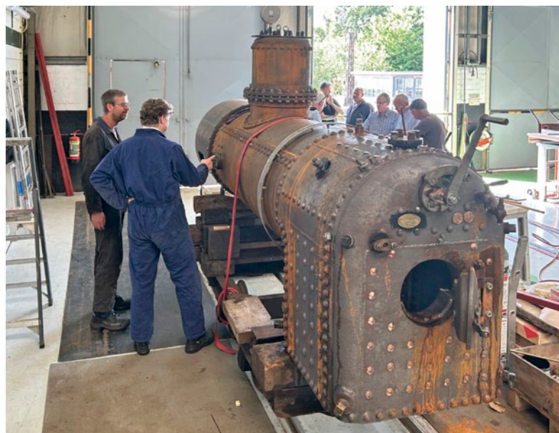
Op 17 juli wordt de ketel van stoomloc 7 onder toezicht van een keurmeester afgeperst onder waterdruk. Foto's: Edwin de Jong (li) en Roel Koolen (re).
