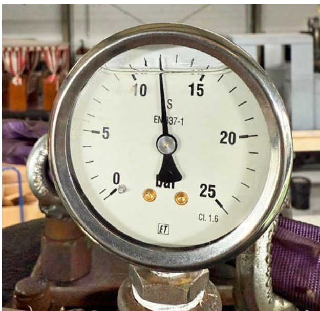
Op 17 juli wordt de ketel van stoomloc 7 onder toezicht van een keurmeester afgeperst onder waterdruk. Foto's: Edwin de Jong (li) en Roel Koolen (re).
