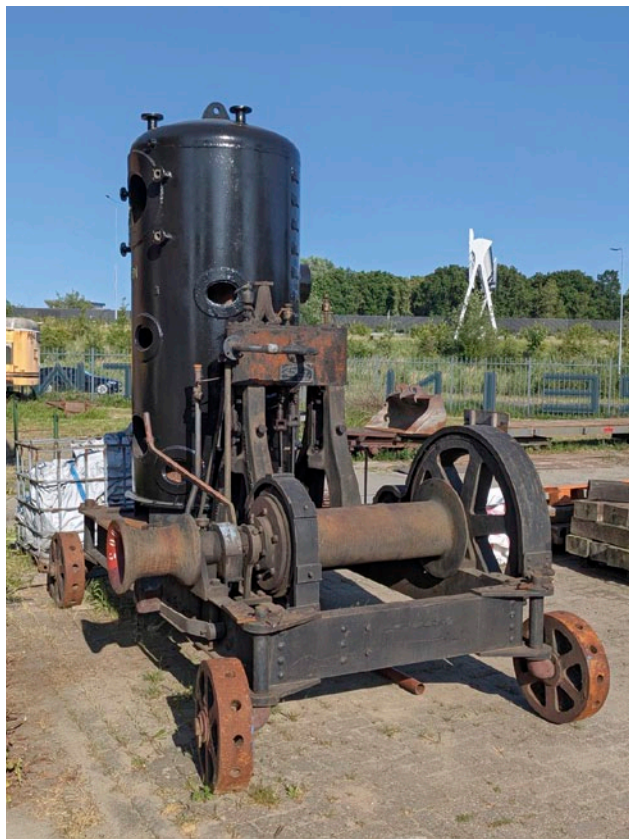
De nieuwe aanwinsten in beeld: Links de bedrijfsvaardige stoomheismachine uit 1904 gebouwd door Figeë. Rechts de O&K MV2 en een kipwagentje van Decauville. Beide in bruikleen van het Decauville Spoorweg Museum. Foto's: Kees Plug (li en ro), Ivo Kaptein (rb) en Arnoud Bongaards (rm).
