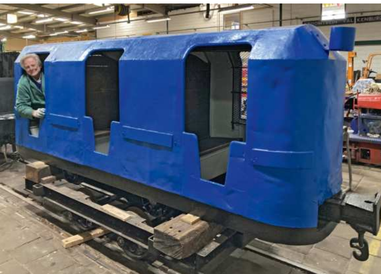
Na jaren is mijnwagen 808 eindelijk af. Adriaan van der Klein, die een groot deel van de restauratie voor zijn rekening nam, laat zien hoe de kompels in de wagens zaten; vier per compartiment. Foto: Pieter van der Ham.
