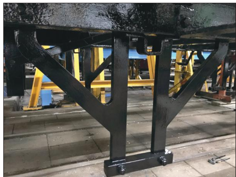
Goederenwagen GTW GV 802 is voorzien van nieuwe scheenijzers naar oud model. Foto: Roel Koolen.
